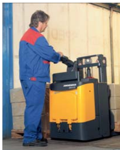
Con plataforma cerrada se puede utilizar también como carretilla de conductor acompañante
