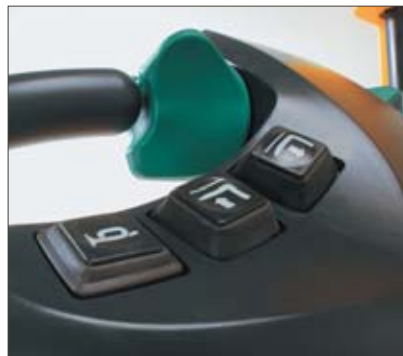
Pulsadores para elevación y descenso suaves así como claxon
