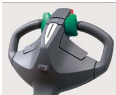
Todas las funciones de traslación y elevación en el cabezal ergonómico multifunciones
