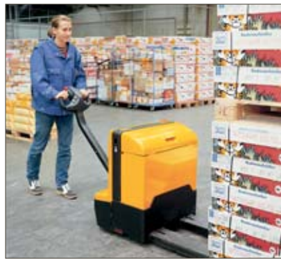
Protección antichoque en el cofre de la batería
