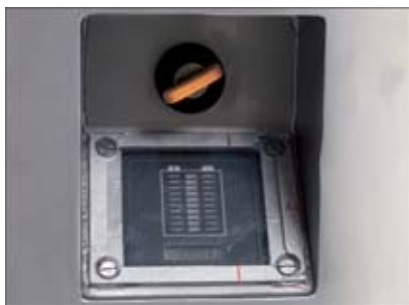
Interruptor de llave y controlador de descarga rebajados
