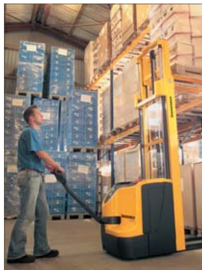
Condiciones de visibilidad óptimas gracias al mástil de elevación esbelto
