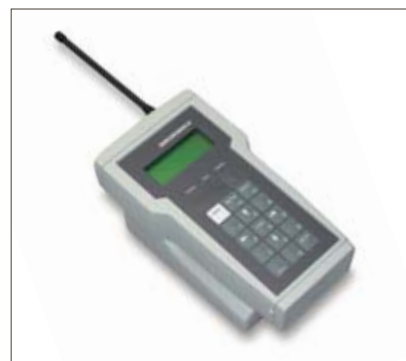
Terminal manual de radiofrecuencia con docking station
